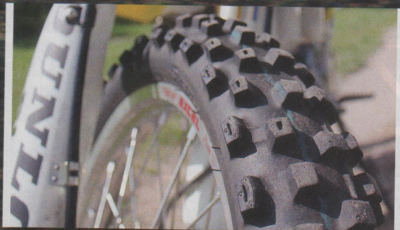
Opona przednia nie przenosi momentu obrotowego i może zużywać się nawet dwa razy wolniej niż tylna (wymiana co 4-5 tys. km)
