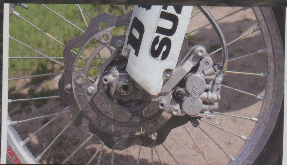
W przypadku klocków hamulcowych, lepiej dopłacić do produktów ze spieków metali, choćby najtańszych. Dwa, trzy komplety starczą na 100 motogodzin.
