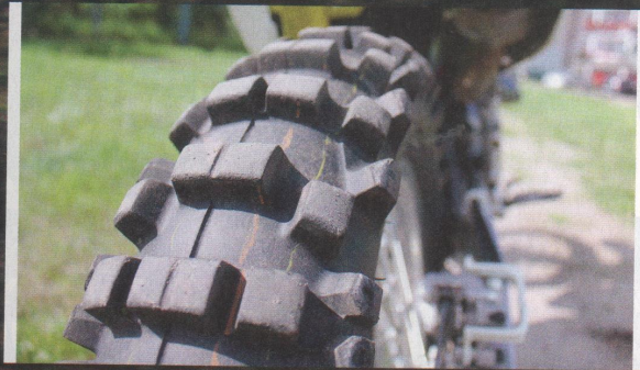
Opona tylna musi przenieść moment napędowy. Wystarcza na jakieś 3 tysiące kilometrów spokojnej jazdy.
